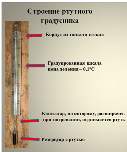
Рисунок 4. Схема устройства ртутного градусника
